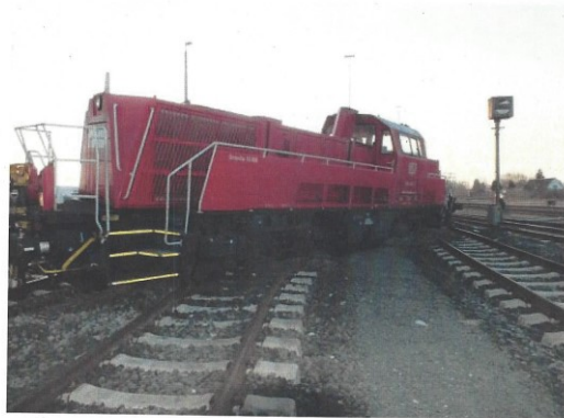
Bild 10, Detailaufnahme beschädigte Rangierlok
